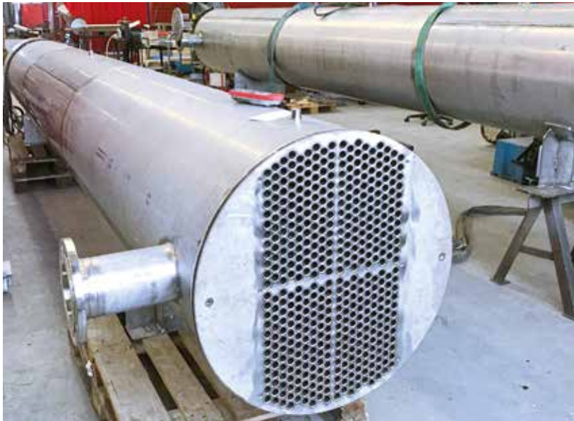
Ein Wärmetauscher kurz vor der Endmontage in den Werkshallen der S Combi AG.
